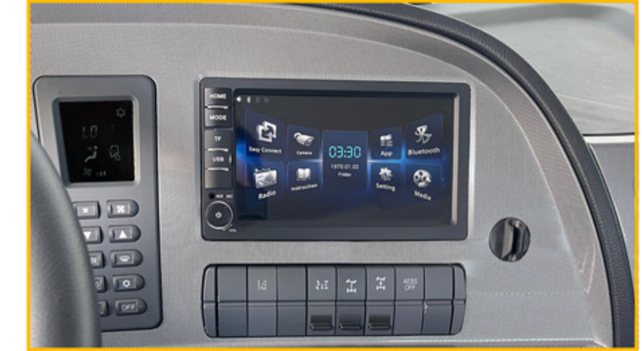
سیستم مولتی‌مدیا TFT لمسی (رادیو، رهیاب، بلوتوث، USB، SD Card)
