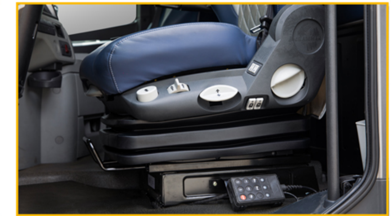
صندلی راننده با تعلیق پنوماتیکی و قابلیت تنظیم در ۶ جهت
