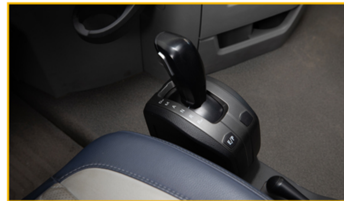
۱۲ دنده اتوماتیک دارای ریتاردر هیدرولیکی ۵ مرحله‌ای
